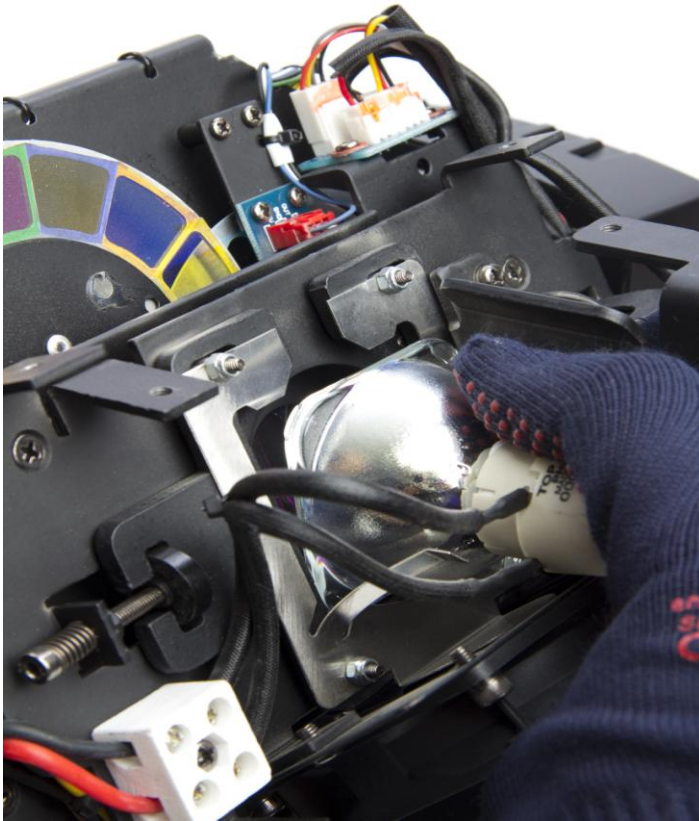
Bild 8 (links neben dem Leuchtmittel finden sie die Inbusschraube zur Positionierung des Brenners)
