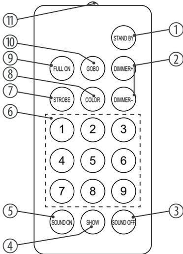
Zum Verwenden der Fernbedienung richten Sie sie mit der Infrarot-Diode auf den Infrarot-Sensor am Gerät aus und drücken Sie die gewünschten Tasten. Die maximale Entfernung vom Gerät liegt bei ca. 9 m. Das Gerät reagiert nur auf die Signale der Fernbedienung, wenn es nicht über DMX gesteuert wird.
