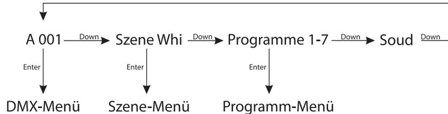
Drücken Sie [DOWN] während „A001“ im Display blinkt, um die vorprogrammierte Szene aufzurufen. Drücken Sie wiederholt [DOWN], um eins der 7 Programme aufzurufen. Drücken Sie ggf. wiederholt [DOWN], um das Gerät in den sound-gesteuerten Betrieb zu versetzen.
