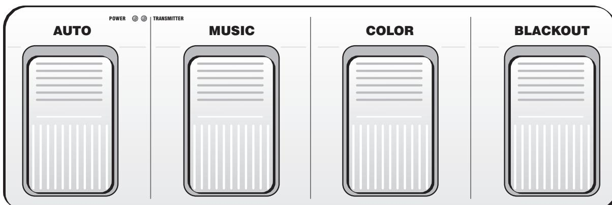
Das Lichtset lässt sich mit dem optionalen Fußschalter über eine Distanz von bis zu 30 Metern (Sichtlinie) fernsteuern. Der Fußschalter funktioniert nur im Standalone-Betrieb, er kann nicht im DMX- oder Slave-Betrieb verwendet werden. Es können die integrierten Showprogramme im Automatikbetrieb oder im musikgesteuerten Betrieb aufgerufen werden oder ein Farbmodus mit vorgegebenen Farben.
