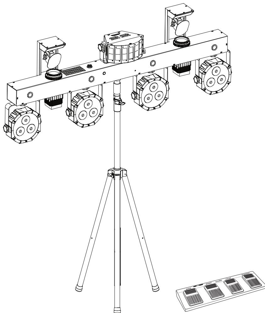
Für den mobilen Einsatz setzen Sie das Lichtset über den TV-Zapfen auf ein Stativ auf und fixieren es mit der Feststellschraube. Passende Stative finden Sie im Kapitel „Zubehör“.
