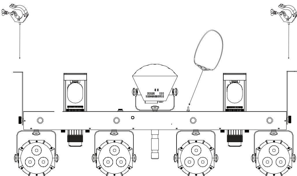
Das Gerät ist zur Überkopfmontage über die beige packten Montagebügel vorgesehen und kann an einer Traverse oder einer anderen geeigneten Struktur befestigt werden. Die Montage darf niemals freischwingend erfolgen.
